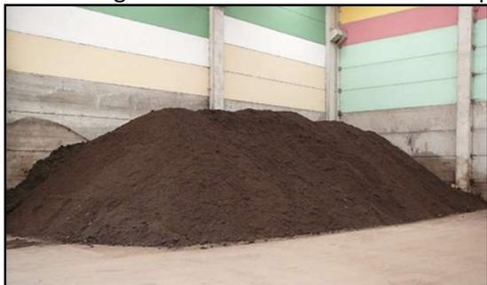
básicos como son la temperatura, la humedad, el pH y la concentración de oxígeno. Para ello, se hacen de forma periódica volteos y riegos en función de las necesidades de cada pila, con el fin de obtener un producto de calidad.
