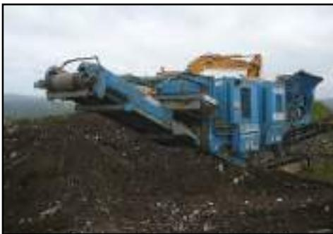
*Imagen: Planta móvil para RCD's*
